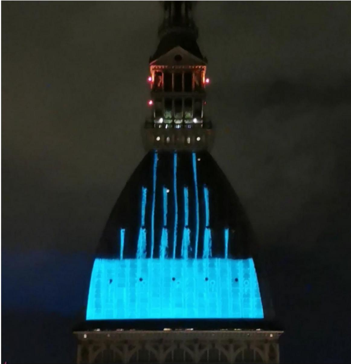
La proiezione sincronizzata delle immagini video è possibile grazie all'investimento tecnico di **Iren**, basato sull'installazione di **8 video proiettori da 20 mila Ansi Lumen**, con tecnologia 3 chip DLP con lampada allo Xenon da 3000 watt. Nello specifico, ad ogni lato della cupola della Mole sono dedicati due proiettori, in grado di lavorare *in stack*, ossia in contemporanea, le immagini video per permettere maggiore visibilità e nitidezza delle immagini stesse.
