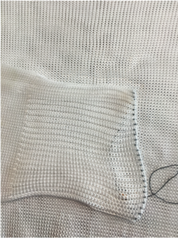
Figura 4: Tessuto realizzato in polietilene (fonte: Svetlana Boriskina).
